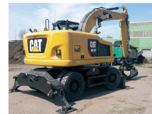
Un nouvel engin a été acquis en 2019 sur le quai de Cléon. M314 F... c'est le nom de cette pelle qui est équipée d'une cabine pressurisée garantissant au conducteur un air filtré de toute impureté.
