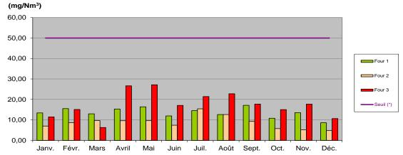
(\*) : Seuil fixé par l'arrêté préfectoral du 06/06/2013 concernant l'UVE de VESTA et par la directive n°2000/76/CE du 04/12/2000 Les valeurs plus élevées constatées entre mai et décembre sont dues à une utilisation accrue de bicarbonate de sodium sur le catalyseur déNox
