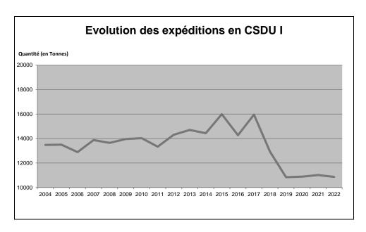
La forte baisse des expéditions en C.S.D.U. de cendres et R.E.F.I.O.M. à partir de 2018 est due à une modification du mode de traitement des fumées (passage d'un traitement dit « semi-humide » à un traitement dit « sec » en cours d'année 2018) et non à une baisse des quantités de déchets traitées sur l'U.V.E.
