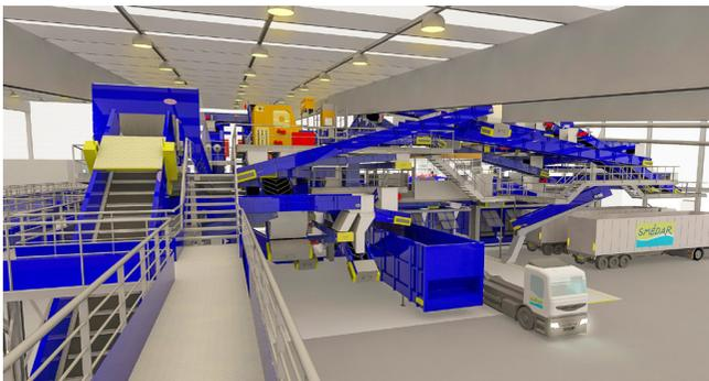
Des passerelles, plateformes d'accès et potences sur les équipements, permettront un entretien plus aisé
